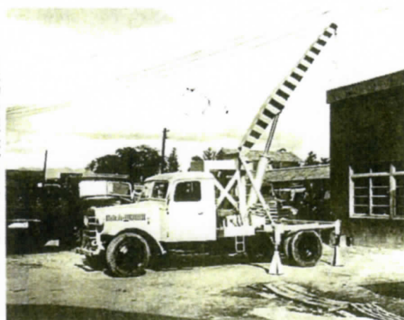
日本初の油圧式トラッククレーン「OC-2型」の1号機
